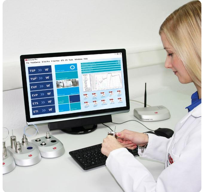
Die E-Val Pro Plus Thermoelemente sind mit USB-Anschlüssen ausgestattet, so dass sie mühelos in das System eingesteckt und wieder entfernt werden können. Das Modul kann als autonome Einheit oder in einem Netzwerk eingesetzt werden, alles passwortgeschützt und reinraumtauglich. Im Gegensatz zu anderen Kabelsystemen kann das E-Val Pro Plus sogar mit Sensoren ausgestattet werden, um [Parameter wie Luftfeuchtigkeit, Druck, CO<sub>2</sub> und vieles mehr zu messen](#).
