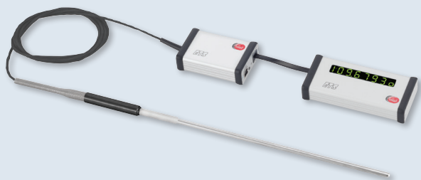
Ellab Temperaturstandard mit optionalem Display
