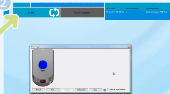
Beginnen Sie die Messung des Datenloggers mit einem Klick auf **Start** und platzieren Sie den SteriSense im Dampfsterilisateur.
