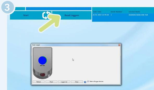
Stellen Sie den SteriSense im Anschluss an das Testprogramm auf die Lesestation zum **Auslesen der Messdaten**.
