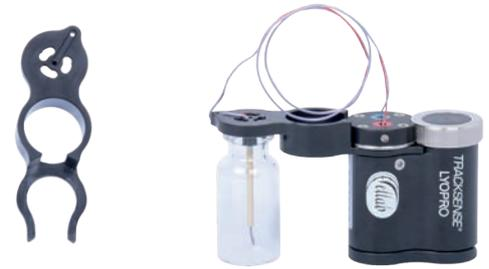
El StopperClip de PEEK también está diseñado para ofrecer espacio para un vial de buffer adicional que se puede colocar entre el data logger y el vial, y se puede fabricar para cualquier dimensión de vial
