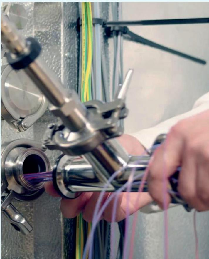
La qualification des performances évalue l'efficacité de la stérilisation de l'autoclave dans des conditions de charge réelles en utilisant des indicateurs biologiques et d'autres outils de validation pour fournir une mesure directe de la stérilité.
